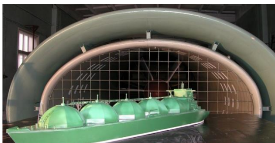
Рис. 2. Экспериментальное определение коэффициента сопротивления воздуха с использованием: а – специального экрана; б – дублированной модели
