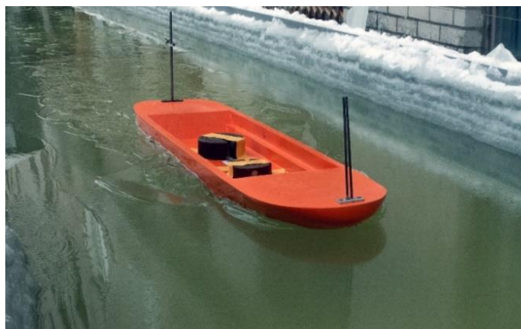
Рис. 7. Движение модели ледокола проекта 1191 во льду толщиной 2,14 мм
