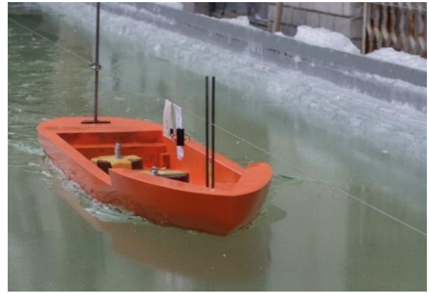
Рис. 6. Движение модели ледокола проекта 1105 во льду толщиной 3,38 мм
