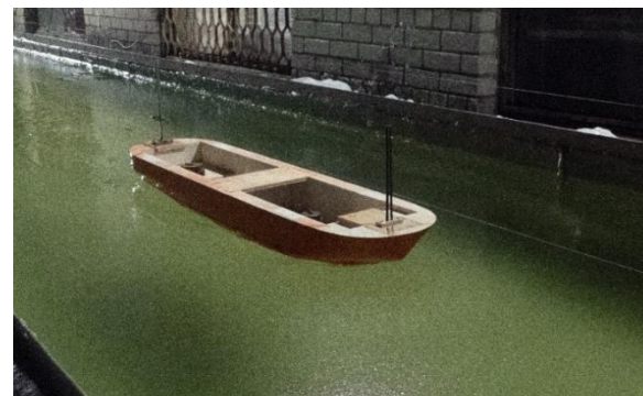
Рис. 8. Движение модели ледокола проекта 21900 во льду толщиной 1,74 мм
