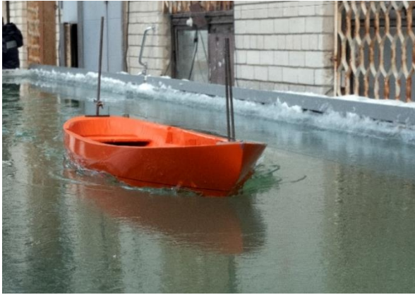
Рис. 5. Движение модели ледокола проекта 16 во льду толщиной 2,72 мм
