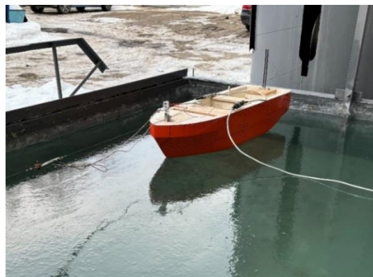
Рис. 9. Буксировка корпуса модели по льду для определения коэффициента трения
