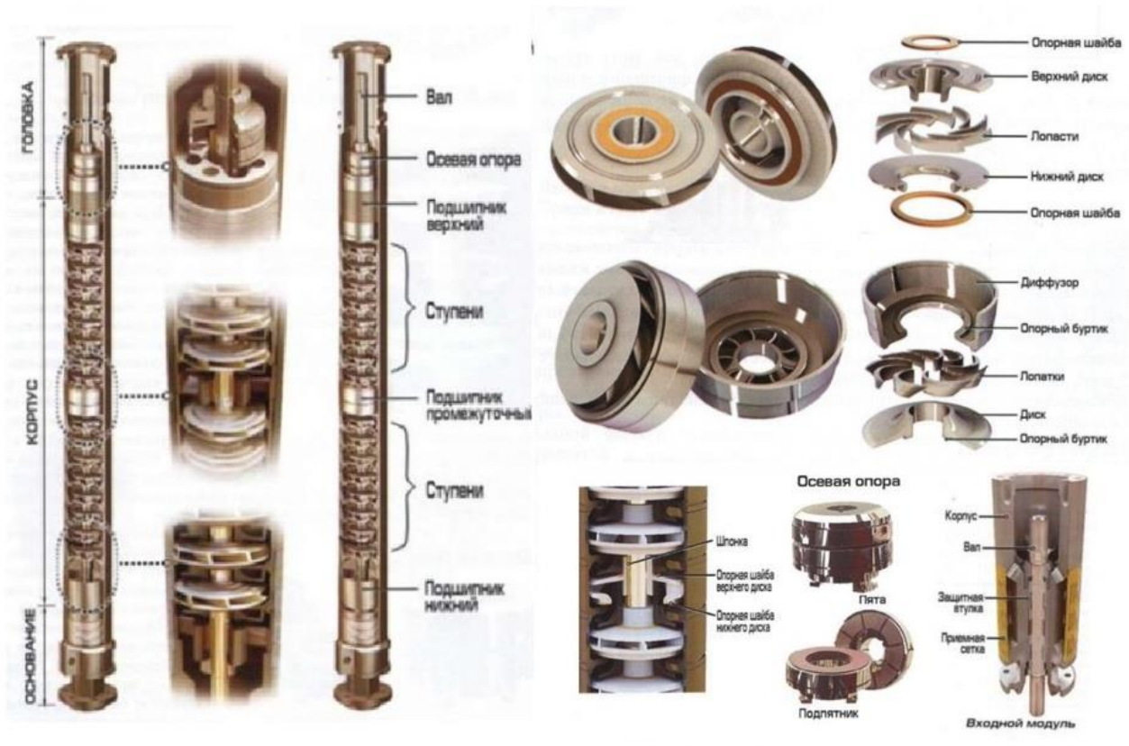
Рис. 3. Принципиальная конструкция погружного насоса
