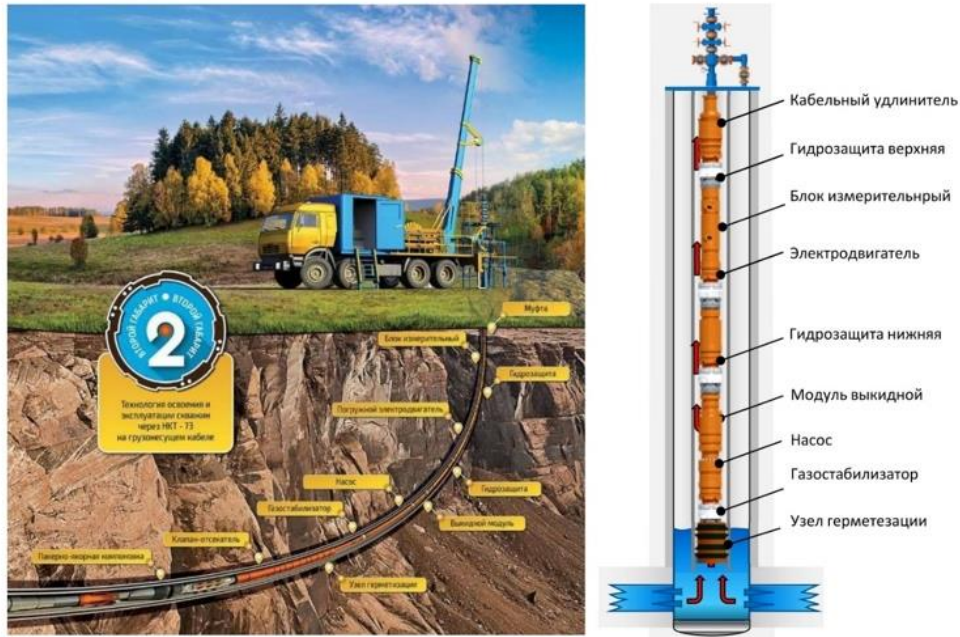
Рис. 10. Технология Colibri ESP на кабель-канате [5]
