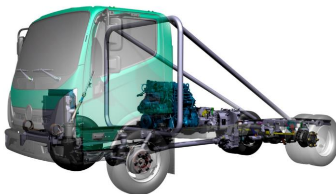
Рис. 2. Компоновка спортивного грузовика «Валдай Next»
