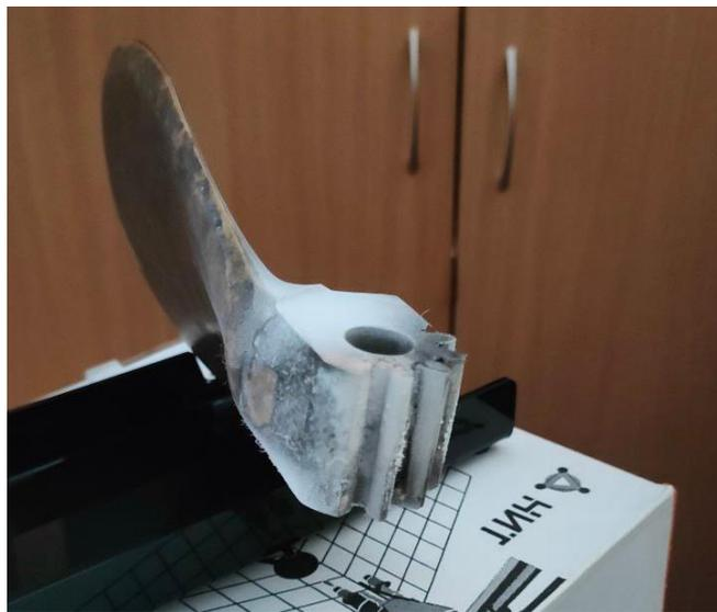
Рис. 3. Матированное зубчатое колесо лопасти гребного винта
