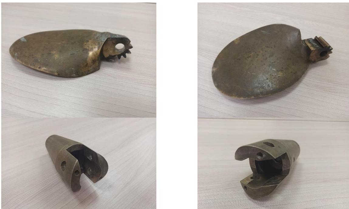
**Рис. 1. Лопасть и ступица гребного винта маломерного судна**
