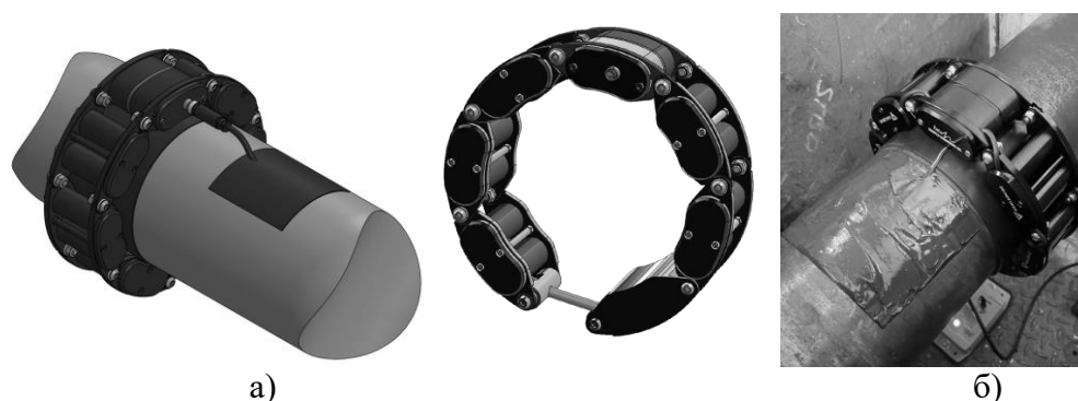
Рис. 4. Измерительная система TorqueTrak SPM-iON компании Binsfeld Engineering [4]: а – внешний вид системы; б – установленная на вал система
