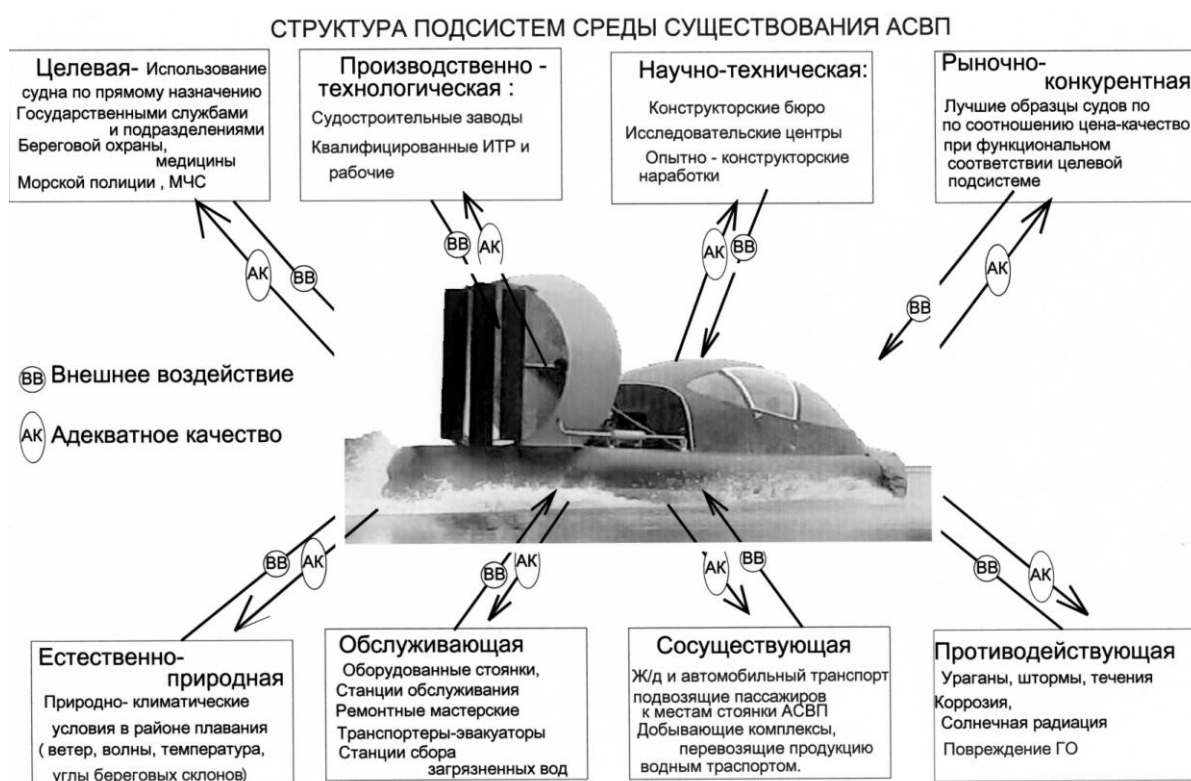
Рис. 1. Структурная схема подсистем среды существования АСВП (на рисунке исходное судно – прототип «Галф»)
