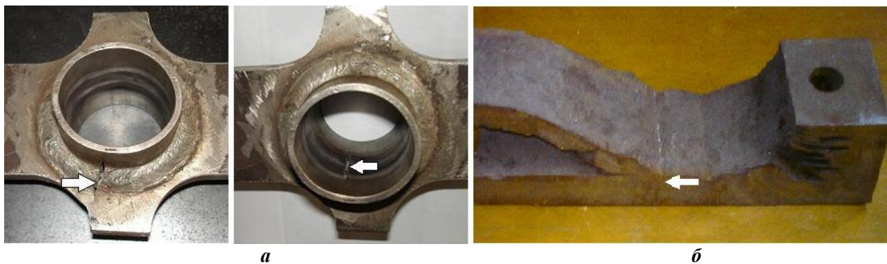
Рис. 1. Сварные узлы для усталостных испытаний (стрелками указаны зоны усталостного разрушения): а – штуцерное соединение; б – соединение рубашки с корпусом сосуда
