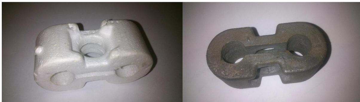
Рис. 2. Пенопластовая газ-модель цевки и ее точная отливка
