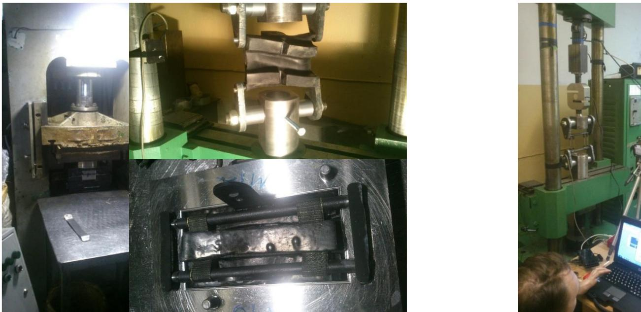
Рис. 3. Обрезинивание трака и испытания на разрывной машине
