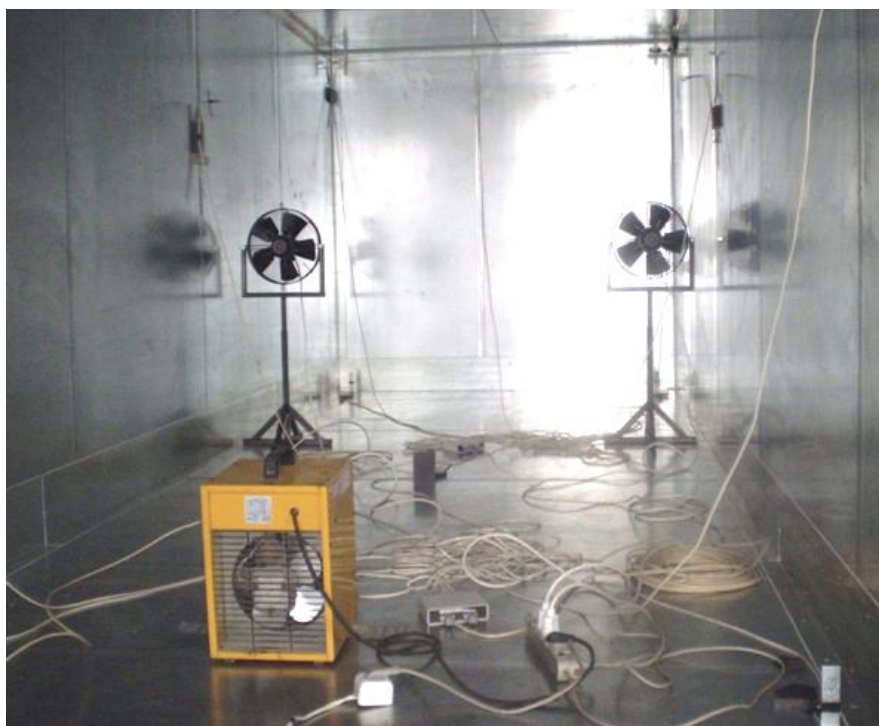
Рис. 3. Оборудование в фургоне для измерения коэффициента теплопередачи
