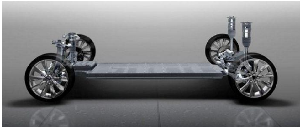
Рис. 2. Размещение аккумуляторов на платформе электромобиля Tesla
