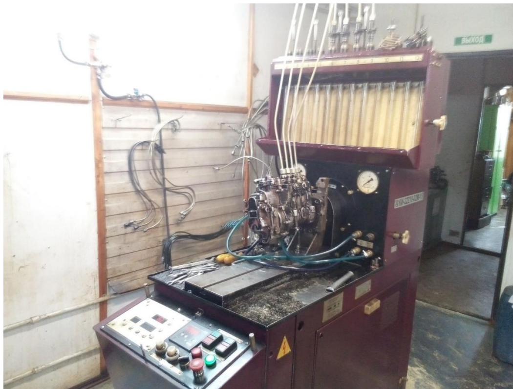
Рис. 1. Стенд для испытания топливной аппаратуры КИ–22210-02М-11
