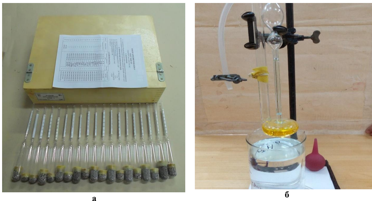
Рис. 3. Приборы для определения свойств топлива: а – набор ареометров; б – вискозиметр ВПЖ-2
