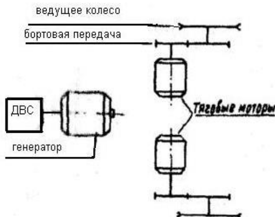
Рис. 3. Схема электромеханической трансмиссии Трансмиссии с параллельными потоками мощности (гидромеханические, планетарные)
