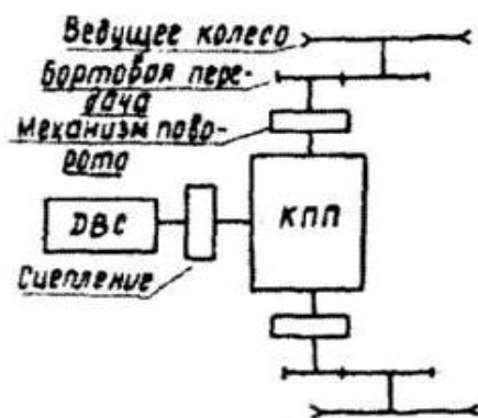
Рис. 1. Схема механической трансмиссии гусеничного шасси без главной передачи
