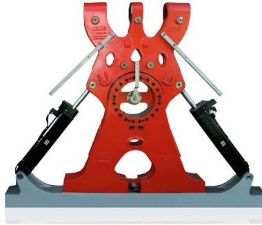
Рис. 1. Система сочленения Hubner-group для автобуса ЛиАЗ 6213.71
