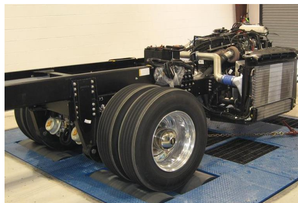
Рис. 10. Роликовые динамометрические стенов компании Mustang Dynamometer: а – MD-250-HD; б – MD-1000; в – MD-7500-HD
