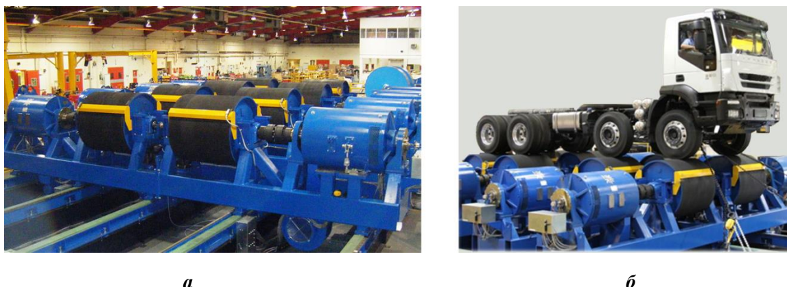
Рис. 8. Динамометрический стенд с беговыми барабанами компании Kratzer Automation: а – общий вид стенда; б – автомобиль во время испытаний на стенде
