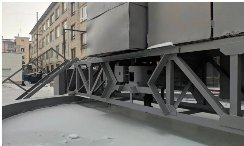
Рис. 2. Стенд для изучения физико-механических свойств ледяного покрова
