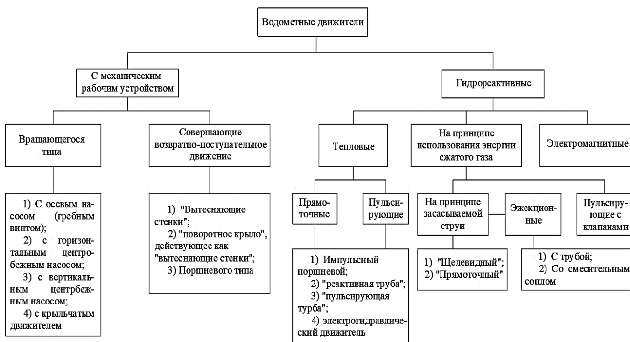
Рис. 1. Классификация водометных движителей
