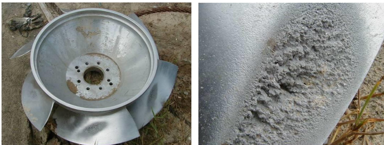
Рис. 3. Пример кавитационной эрозии лопаток импеллера водометного движителя
