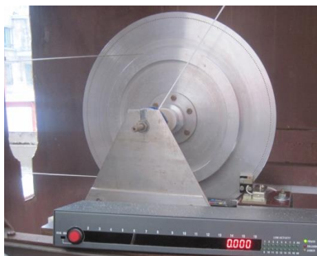
Рис. 8. Ведущий шкив и частотомер для измерения скорости
