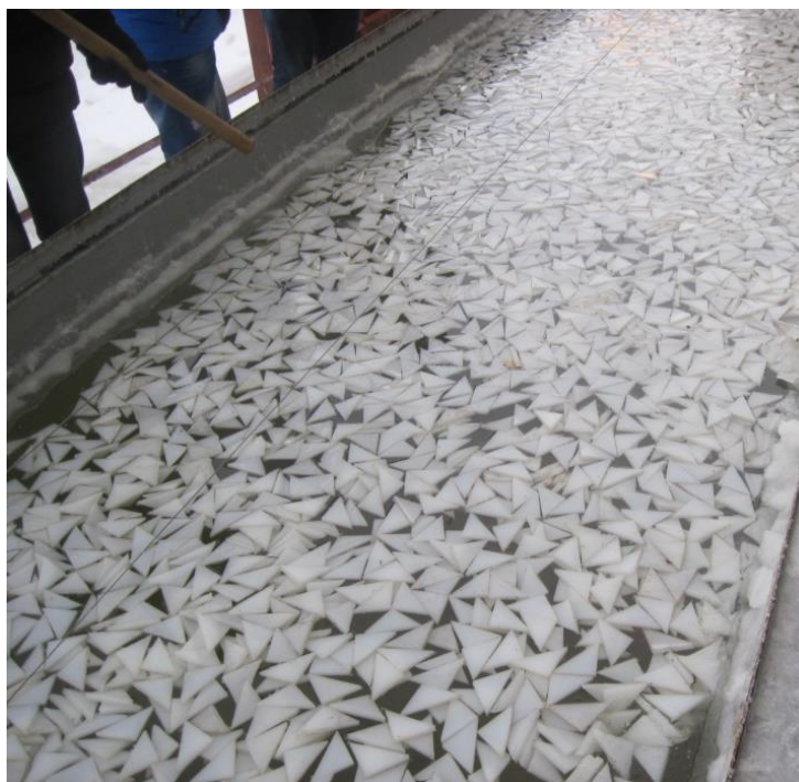
Рис. 15. Бассейн с битым (моделированным) льдом в виде треугольных плиток полиэтилена
