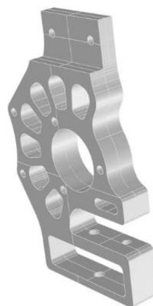
Рис. 2. Трехмерная модель поворотного кулака
