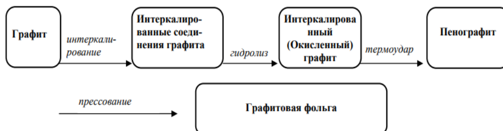
Рис. 1. Основные стадии получения новых углеродных материалов: пенографита и графитовой фольги
