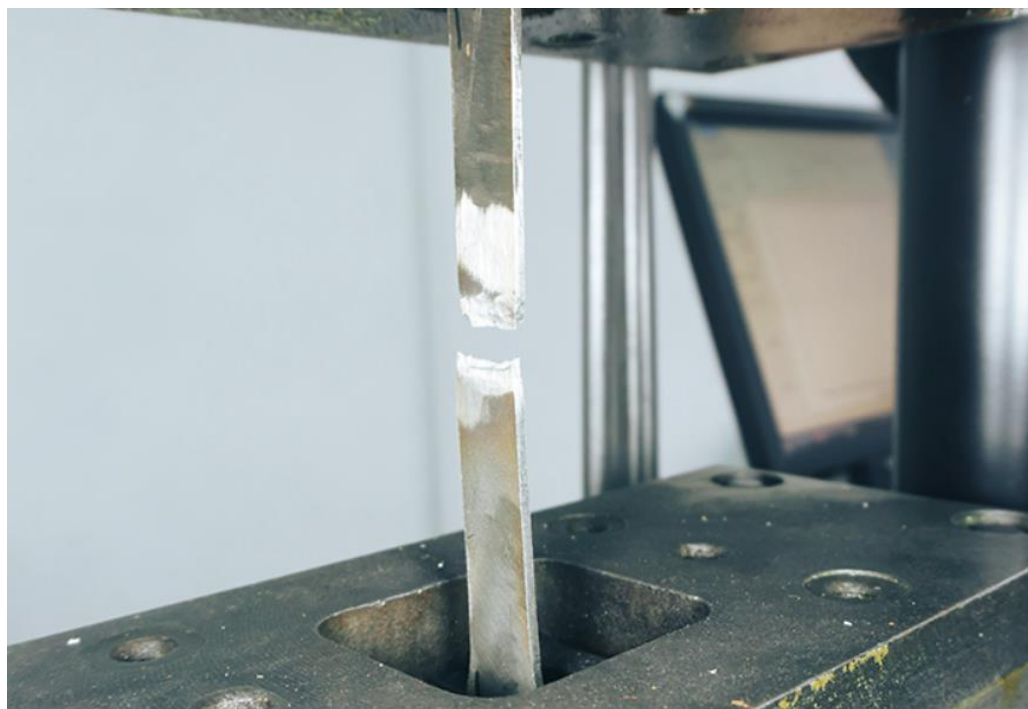
Рис. 8. Испытания образца на разрывной машине
