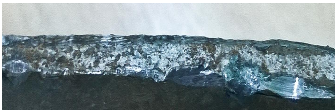
Рис. 4. Характер поверхности излома образца, 20X
