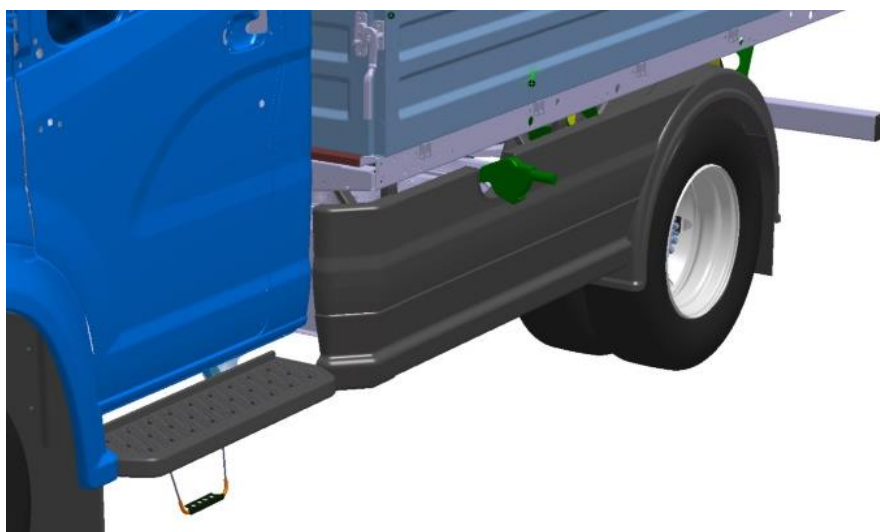
Рис. 2. Вид на боковое защитное устройство с композитной панелью
